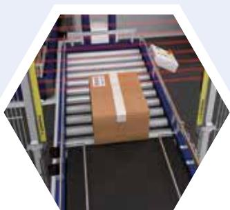
Se a supressão do objecto móvel for parametrizado, altera-se a resolução da cortina óptica. Nas documentações técnicas das diferentes cortinas ópticas são listadas numa tabela as resoluções efectivas mínimas para o cálculo das distâncias de segurança mínimas, segundo a ISO 13855.
