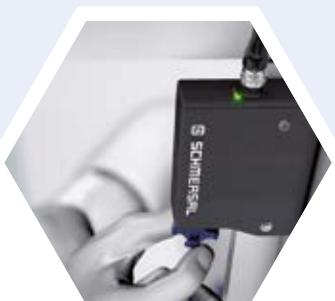
Em várias séries (AZM 200, AZM201, AZM 300, AZM400, MZM 100), a monitorização da posição da porta de proteção não é eletromecânica, mas sim sem contacto - pela tecnologia "Coded Safety Sensor" desenvolvida pela Schmersal, ou por uma tecnologia RFID equipada em termos de segurança técnica. Estas séries oferecem, por exemplo, a vantagem de disponibilizar informações de diagnóstico adicionais ao operador da máquina.
