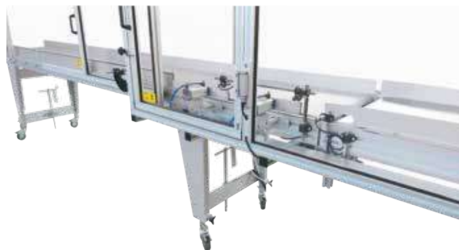
Automazione per riempimento scatole tramite robot Automation for box filling by robot
