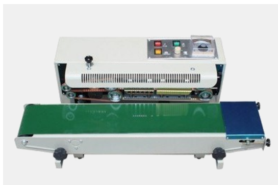
Selagem horizontal Horizontal sealing
